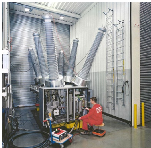
Рутинска испитивања прекидача ЗАР1 DT 245 kV
